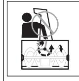
Toccare le parti dell'apparecchio solo quando si sono arrestate completamente.
