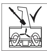
Ne nettoyer le puits d'éjection qu'avec l'outil de nettoyage
