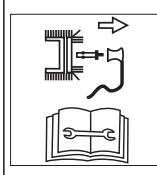
Před všemi pracemi, jako např. nastavením, čištěním, kontrolou atd., přístroj vypněte a vytáhněte nástrčku zapalovací svíčky.
