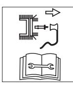
Apparatet slås av og stopselet trekkes ut før alle arbeider som innstilling, rengjøring, avtørring etc.
