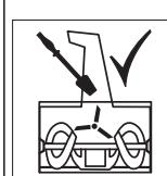
Pulire il pozzetto di espulsione solo con uno strumento per pulire.
