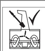
Auswurfschacht nur mit Reinigungswerkzeug reinigen.
