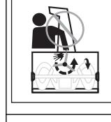
Části stroje se dotýkejte pouze v případě, že jsou v úplném klidu.
