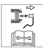
Eteindre l'appareil avant tout travail tel que réglage, nettoyage, contrôle, extinction .. et retirer la prise des bougies.
