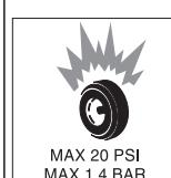
Rischio di esplosione! La pressione massima delle gomme non deve superare max. 1,4 bar/20 PSI.
