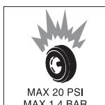
Risque d'explosion ! Ne jamais dépasser la pression maximale des pneus de 1,4 bar/20 PSI.
