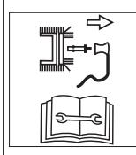
Napravo pred vsemi deli, kot so na primer nastavljanje, èišèenje, preverjanje itd. izkljuèite in izvlecite vtiè za vžigalne sveèke.
