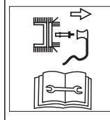
Lülitage masin enne kõiki selliseid töid nagu nt reguleerimine, puhastamine, kontrollimine jne välja ja tömmake süüteküunal välja.
