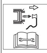
Prije svih radova, poput namještanja, čišćenja, provjere itd., uređaj isključite i izvucite utikač svjećice.
