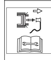
Przed wszelkimi pracami, np. ustawianiem, czyszczeniem, sprawdzaniem itd., wyłączyć urządzenie i wyjąć końcówkę przewodu świecy zapłonowej.
